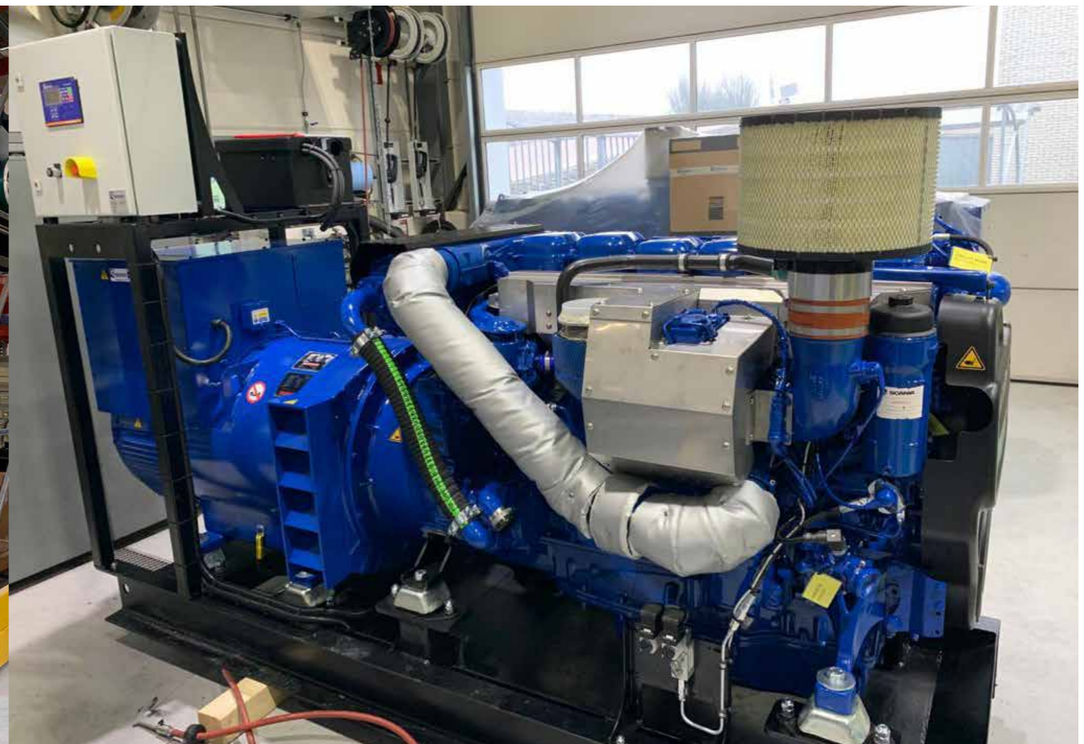
Een compacte en degelijke Stage5 gecertificeerde Scania DC13 bij TVDM.
